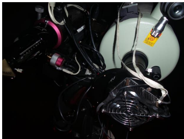
Fig. 39: Imatge de la càmera CCD. Aquesta va acoblada al telescopi i és el que ens permet enregistrar les imatges. Va connectada a l'ordinador amb un cable per poder passar les fotos obtingudes al disc dur.
