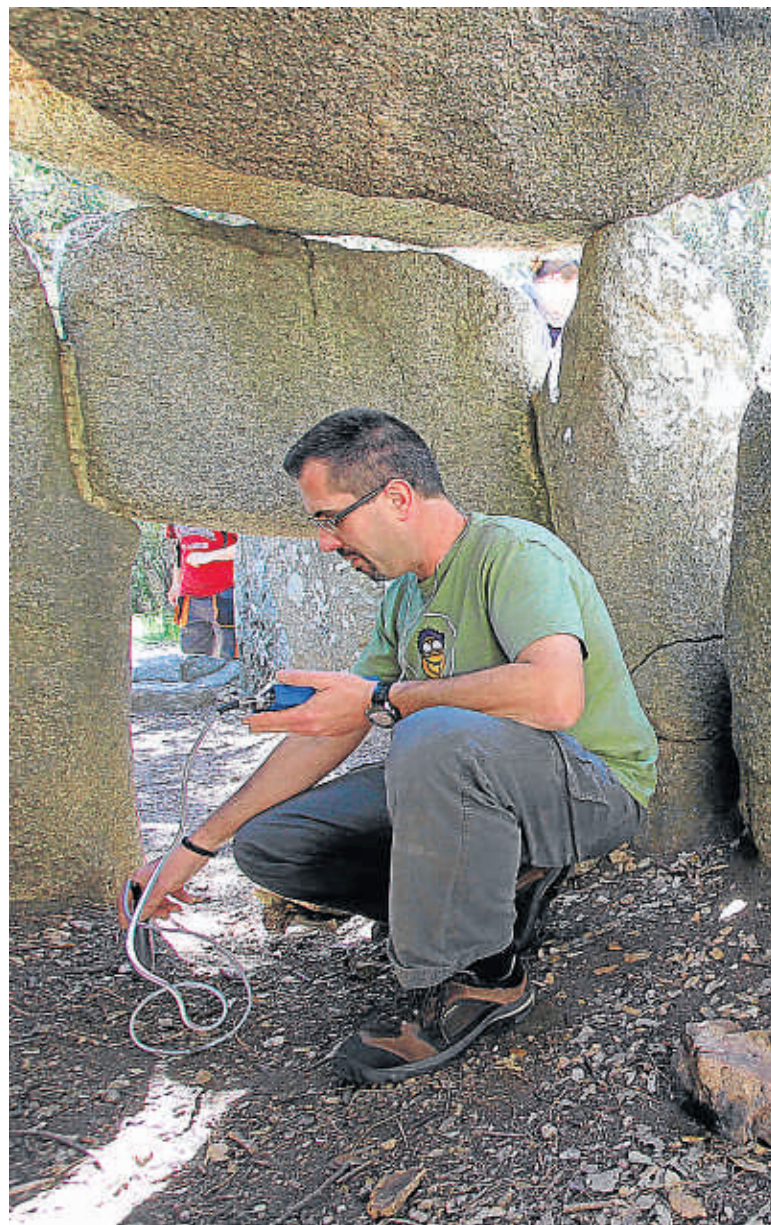
Mesurant el magnetisme. El geògraf Marc Heras fent un mesurament amb un geomagnetòmetre
